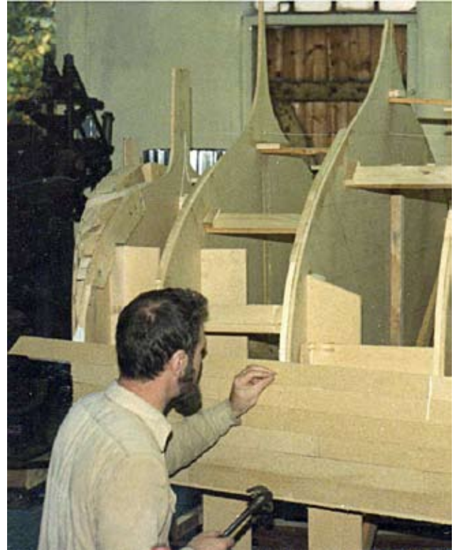
På motsatt sida lite längre akterut håller Ove Nilsson på med bordläggningen.
